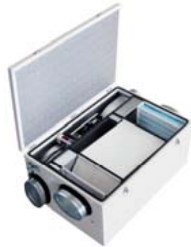
obr. 6.2 Moderní koncepce větrací jednotky s rekuperací tepla s protiproudým výměníkem s účinností 90% a výkonem výkonem až 330 m 3 /h
